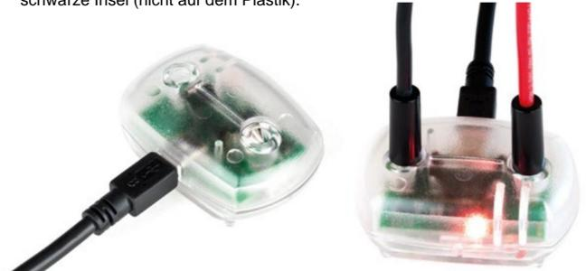
Wenn Sie die Federkontakte verwenden, können Sie die Krokodilklemmen an den Federn befestigen.
